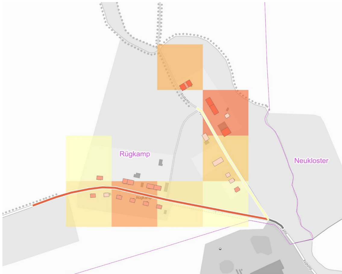
Abbildung 8: Darstellung der Wärmeliniendichte im Ortsteil Rügkamp
